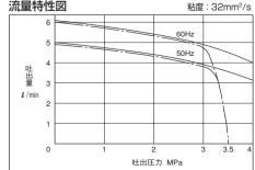
二:基本形 ---:バルブ付 リリーフバルブ設定圧力3.5MPa時
