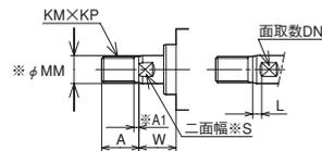
●φ63, おねじ仕様でロッド先端形状 A54, 基準寸法通り
