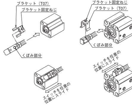
1. ブラケットをスイッチのブラケット取付溝に重ねます。(WR・WS形用のT07ブラケットはブラケット固定ねじをあらかじめゆるめてください。)
