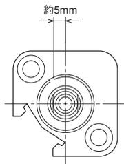
注) 組立て時には上図を参考にストップリングを取付けてください。
