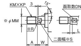
●φ32, おねじ仕様でロッド先端形状 A53, A=50, W=40, ねじM10×1.25, 面取数2, 二面幅位置L=10の場合
