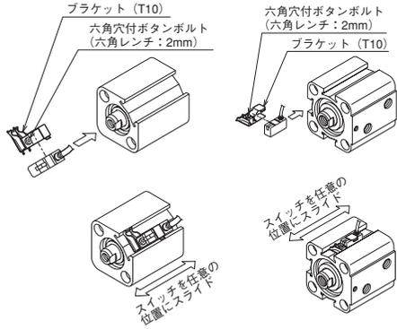
WR・WS形ブラケット固定ねじ締付トルク約0.6N・m
