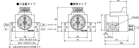
ESF3-M-LRの場合流体の流れ方向が逆になりアダプタの出寸法も逆となります。
