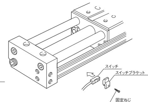
1. スイッチブラケット固定ねじをゆるめスイッチに取付けてください。
