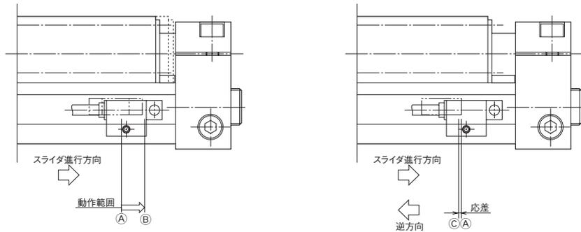
→印の方向にスライダが動いた場合磁石がAの位置にくると、スイッチはONになります。ONの状態はA-B間続き、これを動作範囲とします。
