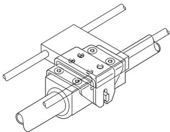
7. ガイド付はリニアボールベアリングなどの外部ガイドとの併用は避けてください。外部ガイドを設けて使用する場合には、スタンダード形に必ずマウント金具を取付けて使用してください。
