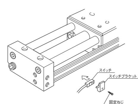
1. スイッチブラケット固定ねじをゆるめスイッチに取付けてください。
