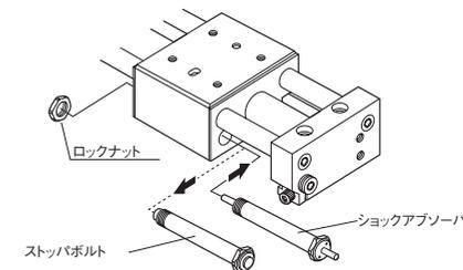
1. ストッパボルト固定用ロックナットを外してください。
