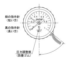
最初に希望する設定圧力まで圧力計の黒い指示針を見ながら圧力を導入してください。次に圧力調整部に精密マイナスドライバーを差し込み、右または左に回転させ緑の設定指示針を動かして電気信号がONまたはOFFした位置で止めてください。
