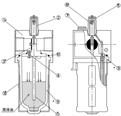
INから入った圧縮空気は③フローセンサのまわりを通してOUTに流れます。
