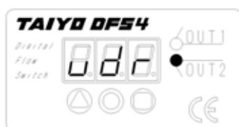
瞬時流量値が最小表示流量(1.6L/min)以下の場合、最小流量警報[UDR]を表示します。
