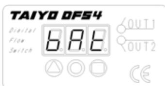
電源電圧が仕様の 10.8V 以下になった場合、電源電圧警報[BAT]を表示します。
