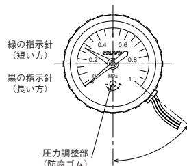
最初に希望する設定圧力まで圧力計の黒い指示針を見ながら圧力を導入してください。次に圧力調整部に精密マイナスドライバーを差し込み、右または左に回転させ緑の設定指示針を動かして電気信号がONまたはOFFした位置で止めてください。
