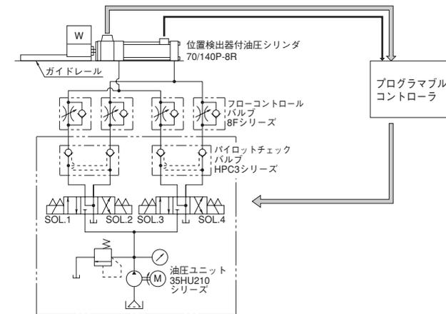
ワークの2段速度制御および多点位置決め制御を行なうシステム
