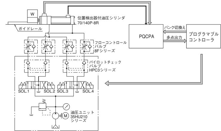
ワークの2段速度制御および多点位置決め制御を行なうシステム
