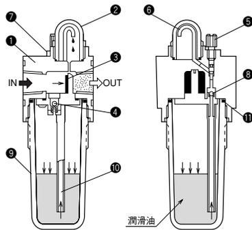
INから入った圧縮空気は、③フローセンサのまわりを通ってOUTに流れます。また、一部の圧縮空気は、④チェックボールAを押し下げ⑤ケース内に流れ込み油面を加圧します。加圧された油は、⑩サイホンチューブを通して⑥ノズルから滴下し、油霧となり給油されます。
