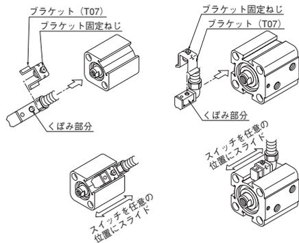
1. ブラケットをスイッチのブラケット取付溝に重ねます。(KR・KS形用のT05ブラケット・WR・WS形用のT07ブラケットのブラケット固定ねじはあらかじめゆるめておいてください。)
