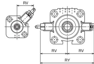
注) WR・WS形スイッチのコード最小曲げ半径は25mm以上必要です。
