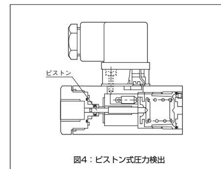
図4：ピストン式圧力検出
