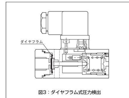
図3：ダイヤフラム式圧力検出
