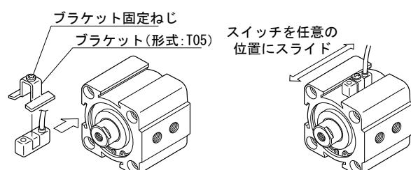
1. シリンダストローク端検出の場合は、スイッチのコード部が、シリンダ中央側へ向くようにしてください。
