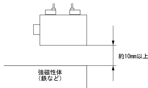
また周囲に強力な磁界が発生する場所では、鉄板等で磁界を遮断してください。
