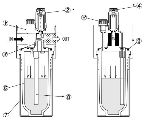
INから入った圧縮空気は③フローセンサのまわりを通してOUTに流れます。
